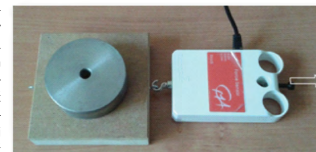
Rys. 5.2. Zestaw pomiarowy z czujnikiem siły do badania tarcia statycznego i kinetycznego przy różnych wartościach siły nacisku. Ciężar klocka 3 N, obciążnika 10 N.
