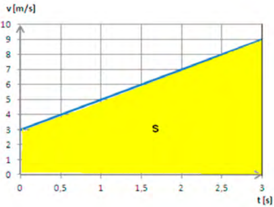
Rys. 2.6. Wykres prędkości od czasu w ruchu jednostajnie zmiennym prostoliniowym.
