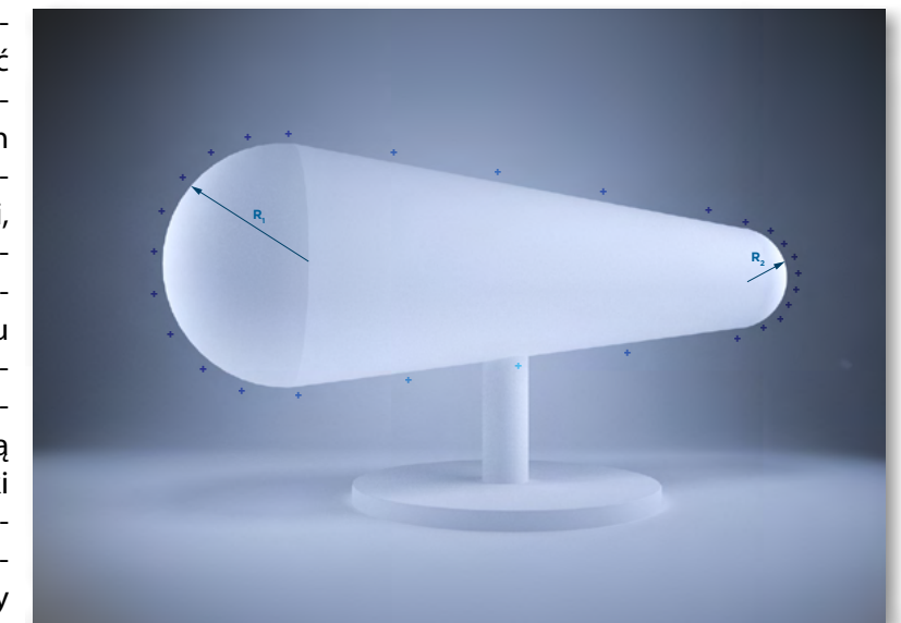
Rys. 9.09. Rozkład ładunku na powierzchni przewodnika.
