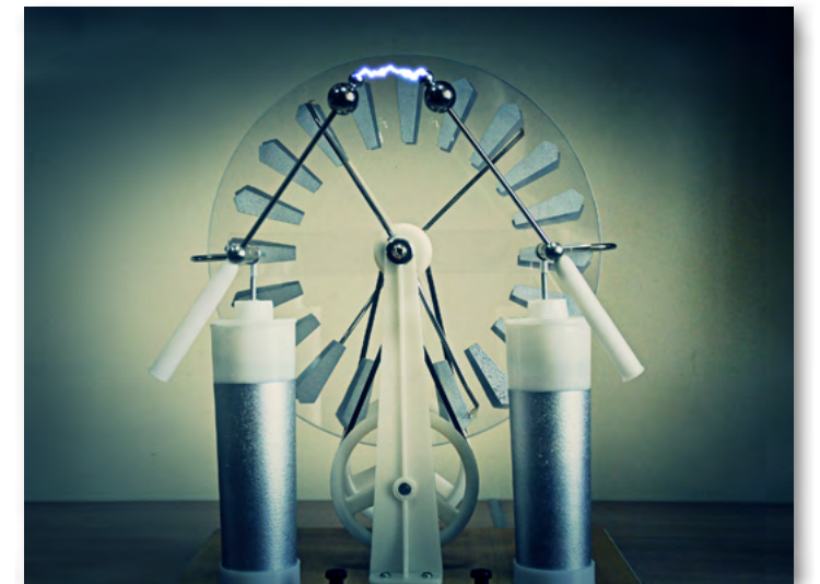
Rys. 9.18. Przeskok iskry między kulkami maszyny elektrostatycznej.
