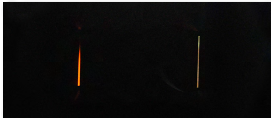
Rys. 2.13. Obraz świecącego sodu uzyskany za pomocą spektroskopu.
